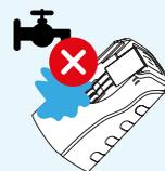
**PARA A LIMPEZA DA UNIDADE PRINCIPAL ONDE ESTÁ O CIRCUITO ELÉTRICO, USE UMA GAZE LEVEMENTE ÚMIDA E PASSE DELICADAMENTE, REMOVENDO AS SUJEIRAS. JAMAIS USE ÁGUA CORRENTE.**
